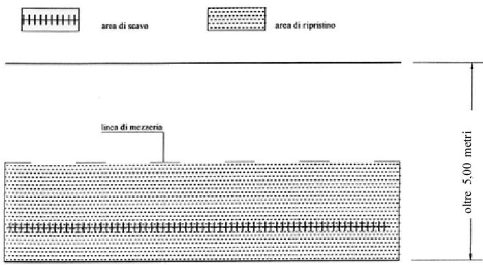
figura 7 scavo longitudinale alla carreggiata
